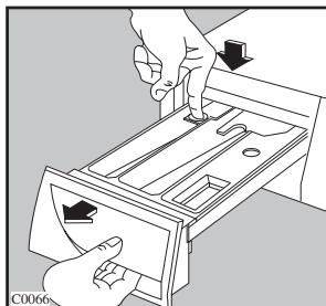
Для облегчения чистки можно снять верхнюю часть отделения для добавок. Промойте водой все детали дозатора.
