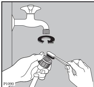
Закройте кран подачи воды. Открутите наливной шланг. Прочистите фильтр жесткой щеткой. Прикрутите на место наливной шланг.
